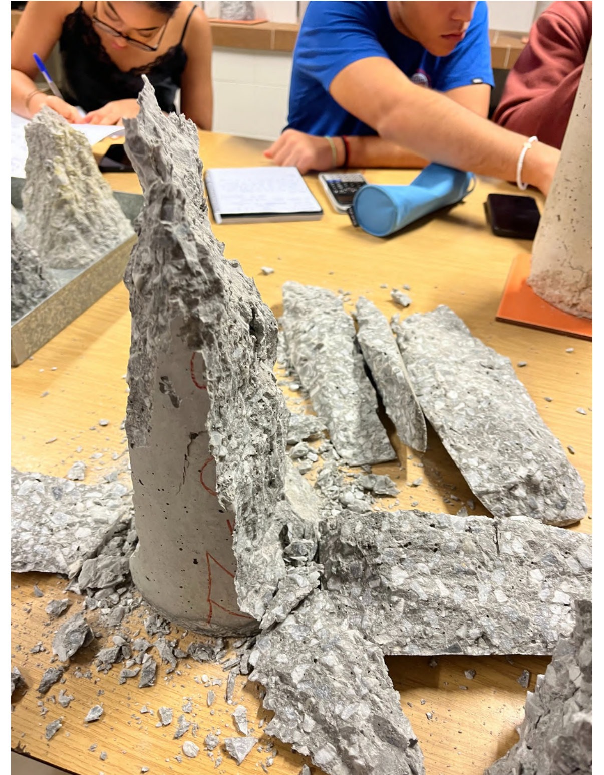
Photographie d'un échantillon de béton, après essai de compression
