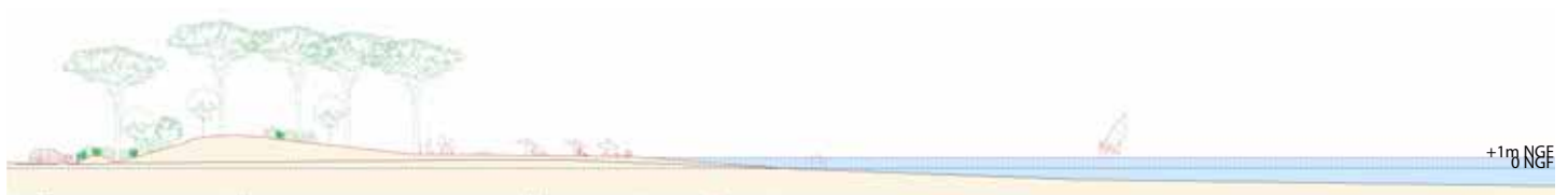
Coupe C-C : Retrait et renforcement du cordon dunaire
